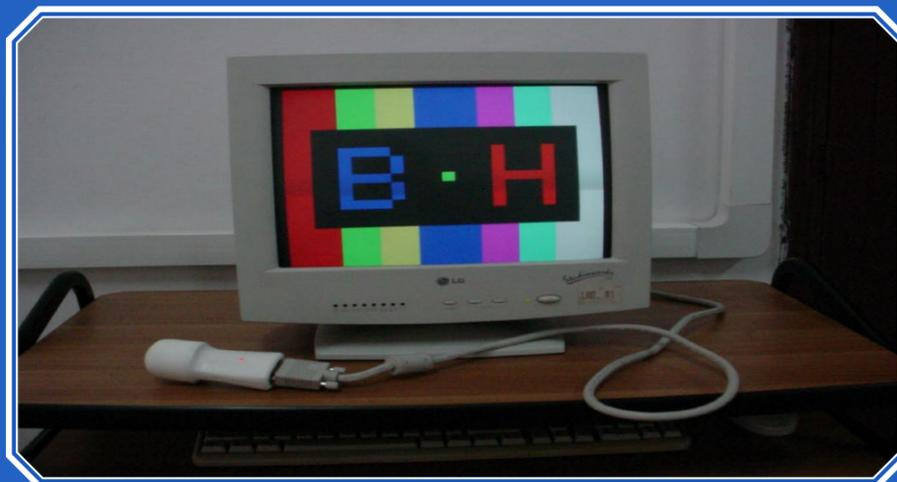
Figura 4. Generador de patrón VGA
