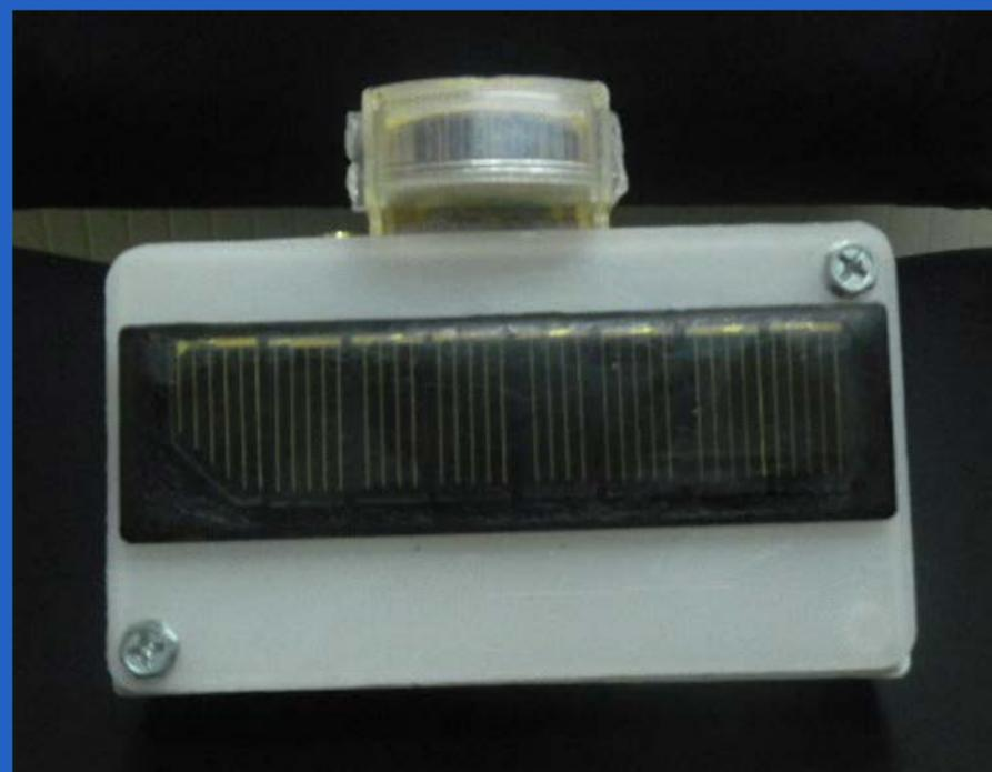
Figura 2. Probador de mandos a distancia construido
