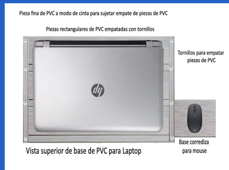
Fig. 3. Vista superior de base de PVC para laptop.
