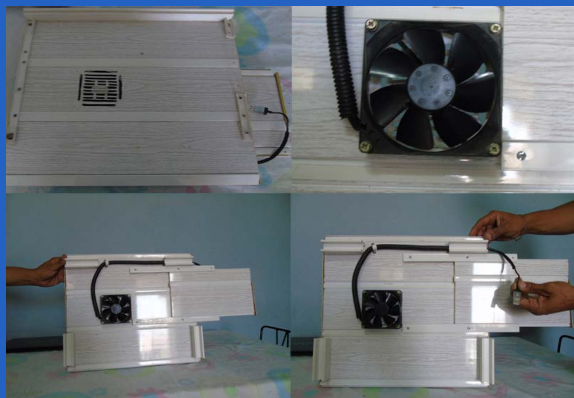
Fig. 1. Base de PVC con ventilador USB para ordenador portátil.
