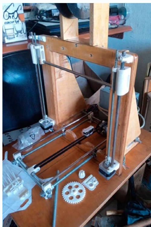
Fig. 2. Forma de tensar la correa para mover la cama caliente
