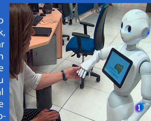
Fig. 3. Pepper, robot diseñado para dar apoyo emocional a las personas
