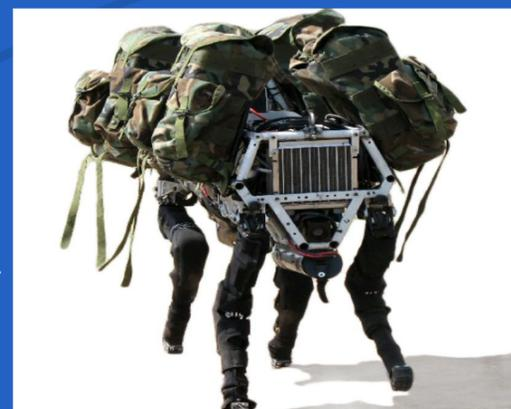
Fig. 2. Bigdog, robot cuadrúpedo empleado para búsqueda y rescate
