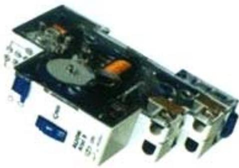
Concebido para controlar el tiempo de encendido de cualquier equipo eléctrico o electrónico conectado a él, cuyo consumo de corriente no sea superior a 30A, el mismo nos permite controlar tiempos desde 0 a 120 minutos mediante la variación de un potenciómetro. Esto nos permite ahorrar energía eléctrica, además de automatizar procesos que requieren el control del tiempo de trabajo de determinados equipos.
