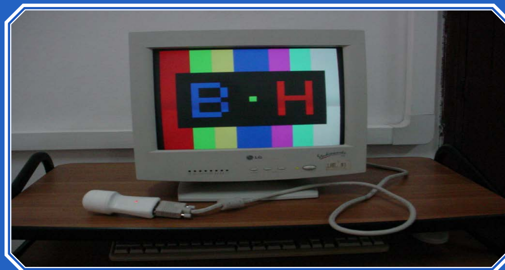
Figura 4. Generador de patrón VGA
