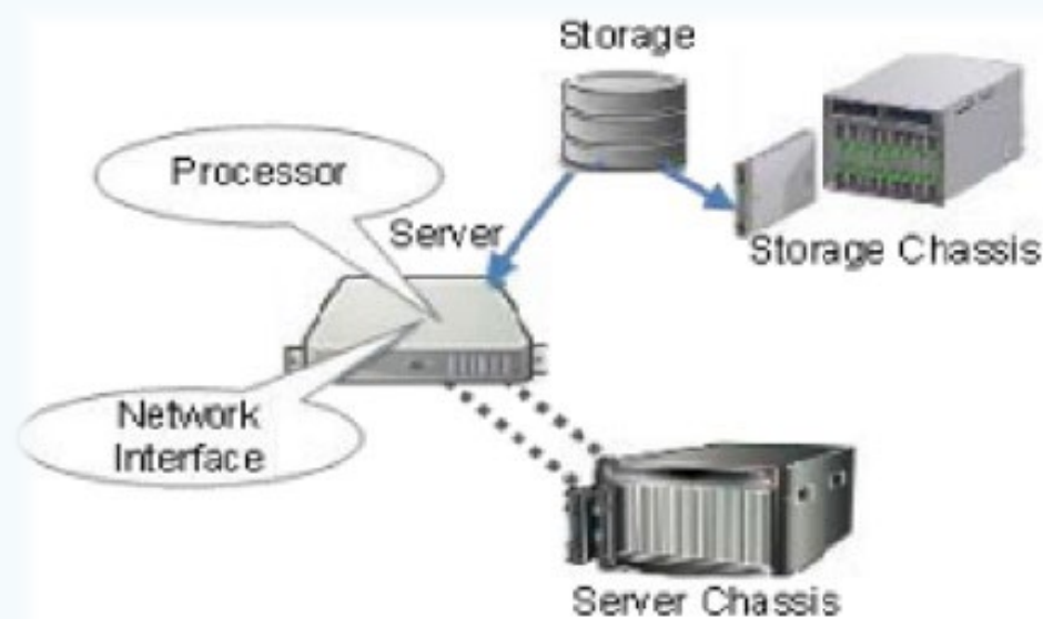
Figura 4. Componentes físicos dentro de NFVI.
