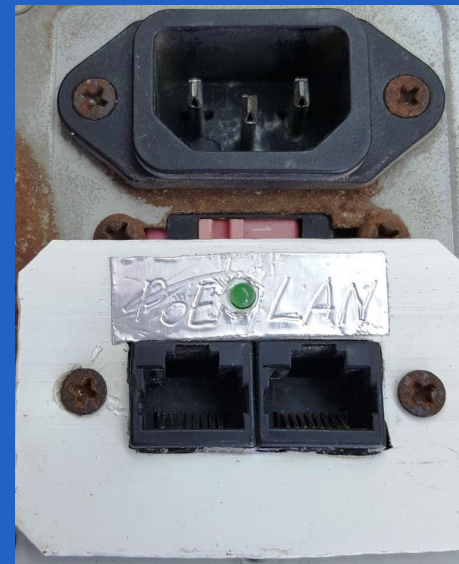
Figura. 7: PoE integrado al chasis de la fuente.
