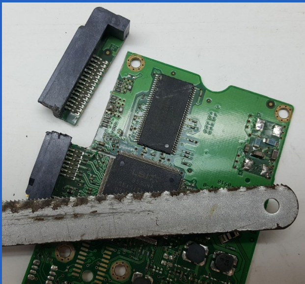
Fig 4. Con una segueta, se corta el conector SATA macho, de la placa controladora.
