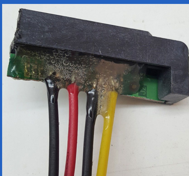
Fig 8. Cubrir con silicona, las soldaduras realizadas, para evitar cortocircuitos.
