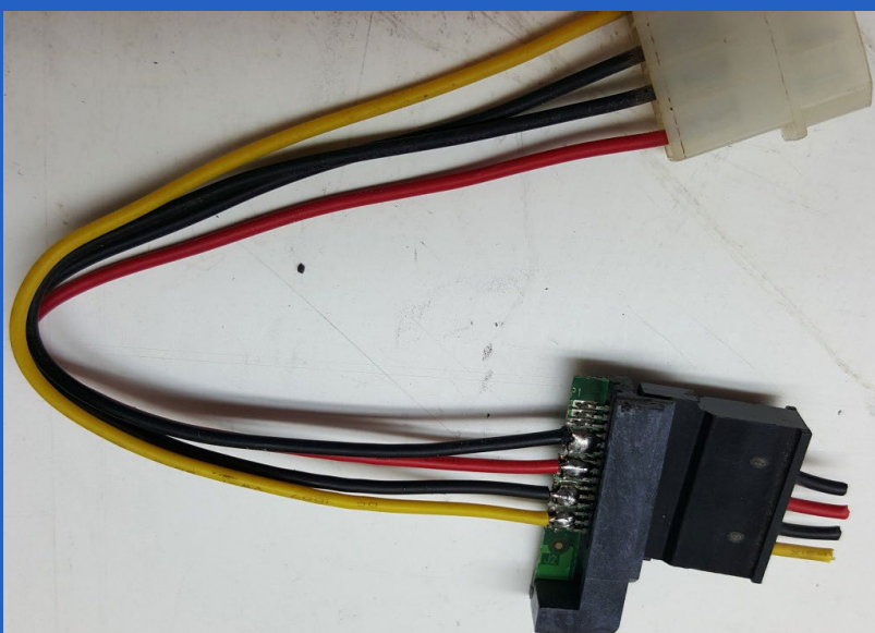
Fig 6. Los cables del conector Molex se sueldan, como se indica.
