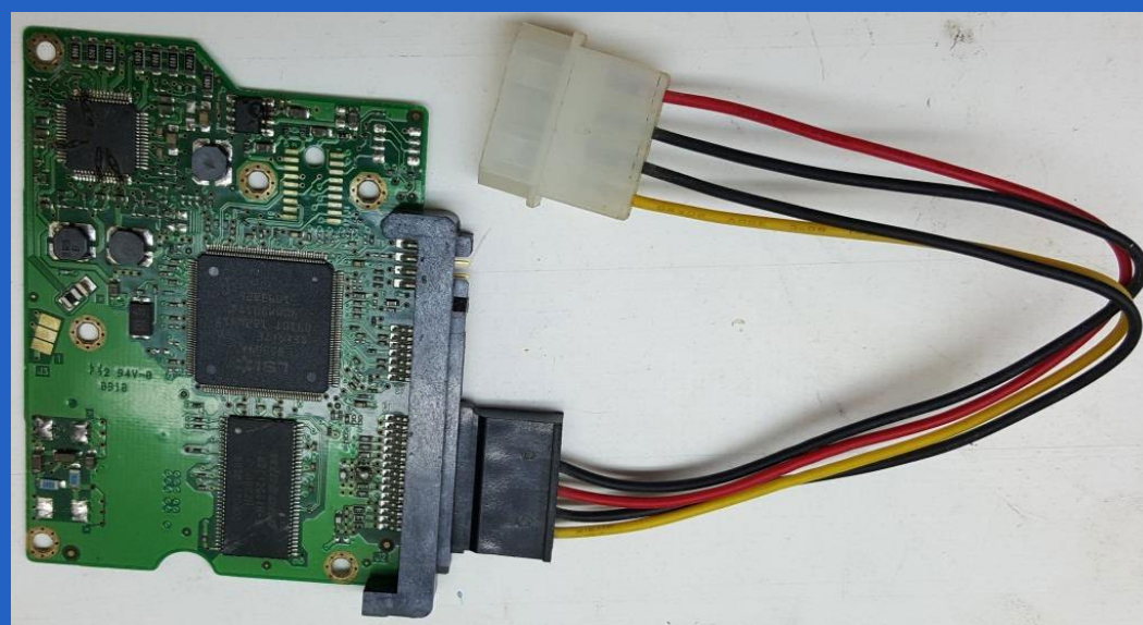
Fig 2. Placa controladora (defectuosa) de un disco duro SATA conectada a un adaptador Molex-SATA.
