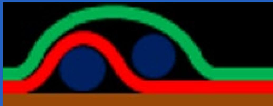
Fig. 1. Esquema de la vista transversal de las capas de cinta adhesiva, que aíslan los extremos libres de los alambritos.
