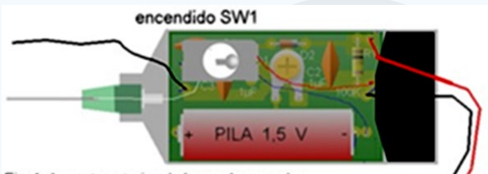
Fig. 4. Esquema del aspecto exterior de la sonda de RF ya armada
