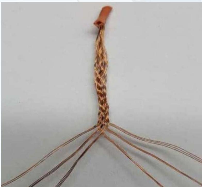
Fig. 3. Trenzado de la malla desoldadora casera
