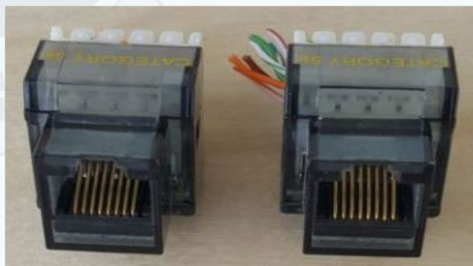
Fig. 3. Conectores RJ45 (hembra) recuperados de un patch panel
