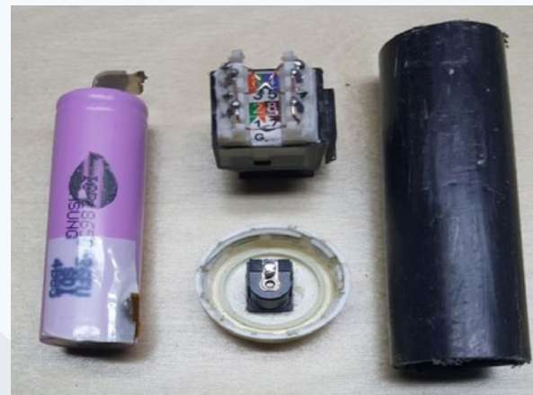
Fig. 9. Materiales para armar el terminal que proporciona la tensión de alimentación
