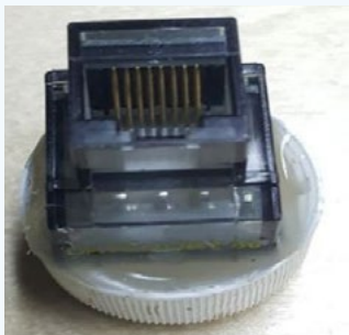
Fig. 7. Terminal donde se indica el estado de los pares trenzados
